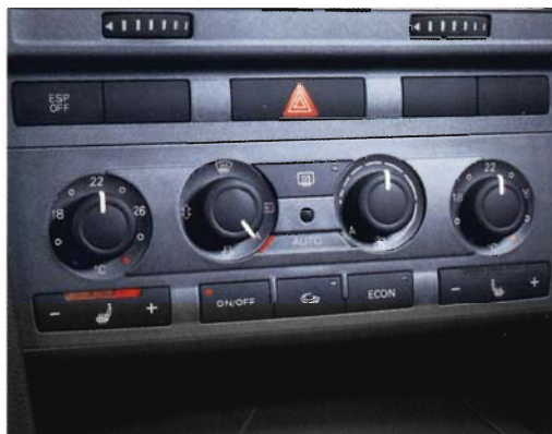
Komfortklimaautomatik mit sonnenstandsabhängiger Regelung, getrennte Temperaturverteilung für Fahrer- und Beifahrerseite, Umluftbetrieb, Pollenfilter, Schlüsselkennung
