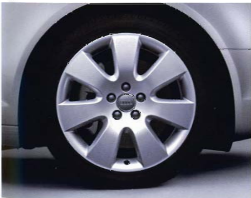
Aluminium-Gussräder im 7-Arm-Design Größe 8 J x 18 mit Reifen 245/40 R 18
