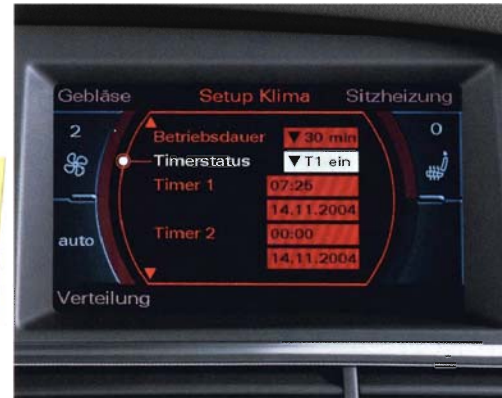
Standheizung/-lüftung mit Timer und separater Funkfernbedienung mit Funkrückmeldung; für einen angenehmen Aufenthalt im Fahrzeug, auch wenn Sie nicht unterwegs sind; die Heizung erwärmt den Innenraum und hält die Scheiben eisfrei, die Standlüftung führt Frischluft zu und senkt die Innenraumtemperatur; inklusive Kraftstoffbehälter 80 l
