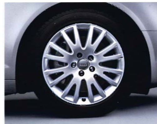
Winterräder: Aluminium-Gussräder im 16-Speichen-Design Größe 7 J x 17 mit Winterreifen 225/50 R 17 H, zulässige Höchst- geschwindigkeit 210 km/h
