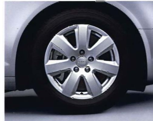
Winterräder: Aluminium-Schmiedeleichtbauäder im 7-Arm-Dynamik-Design Größe 7 J x 16 mit Winterreifen 205/60 R 16 H (für 2.0 TDI und 2.4) oder 225/55 R 16 H (nicht für 4.2 quattro), zulässige Höchstgeschwindigkeit 210 km/h
