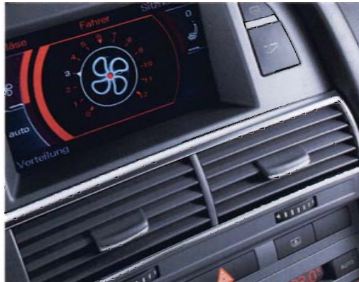
Belüftungssystem Vier separat einstellbare Ausströmer in der Armaturentafel sorgen für gute Belüftung; Stellräder bei eingeschaltetem Licht beleuchtet
