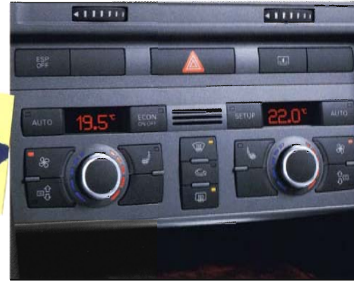
Komfortklimaautomatik plus (Serie bei 4.2 quattro), zusätzlich zur Komfortklimaautomatik getrennte Luftverteilung für Fahrer- und Beifahrerseite indirekte Belüftung, Klimatisierung des Fondraums über Luftausströmer in den B-Pfosten, automatische Umluftregelung durch Luftgütesensor, Taste für Schnellentfrostung, kombinierter Schadstoff- und Pollenfilter, Luftfeuchtesensor
