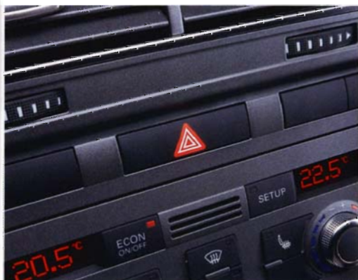
Notbremsanzeige mit automatischer Aktivierung der Warnblinkanlage bei einer Not- bremsung, um den nachfolgenden Verkehr zu warnen
