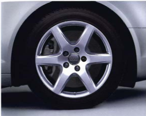
Aluminium-Gussräder im 6-Arm-Design 1 mit Notlaufeigenschaften PAX-System, vier Räder in der Größe 225 x 460 (ent- spricht 17") mit Reifen 235/660 R 460, nur in Verbindung mit Reifendruck- Kontrollsystem
